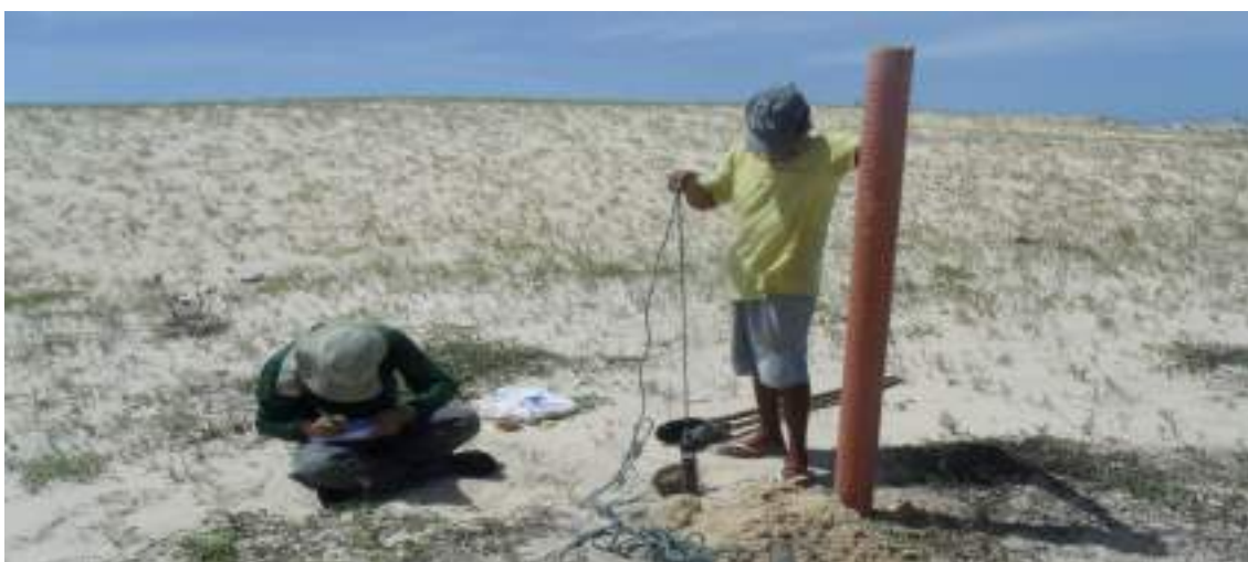
Foto 7.55: Furo com trado manual e sonda manual, utilizando-se de tubo de 4" PVC ranhurado para facilitar o fluxo da água subterrânea. Coleta de sedimentos do Aquífero Dunas e medida de nível estático e parâmetros físico-químicos in situ na AII do empreendimento. Fonte: Engesoft, 2016.
