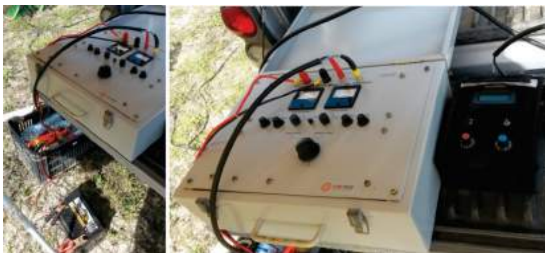
Foto 7.27: Eletorresistivímetro (CTRL TECH) utilizado na medição dos dados elétricos na área do estudo. Fonte: Engesoft, 2016.
