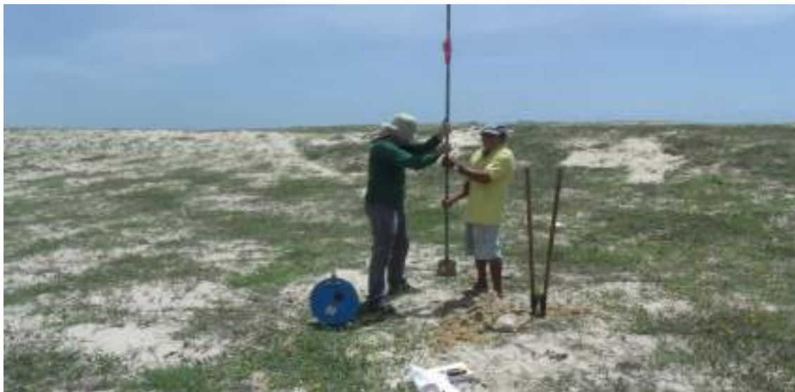
Foto 7.52: Furo com trado manual até o nível estático, sendo este medido com medidor eletro-sonoro Jaciri – localizado entre a faixa de praia e a ADA, na AID do empreendimento. Fonte: Engesoft, 2016.
